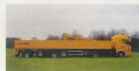
Met het PAS-systeem van Floor hoeft de chauffeur na het lossen van een deellading niet meer de restlading te herschikken; een automatisch luchtvering regelsysteem regelt het draagvermogen van de laatste as.
