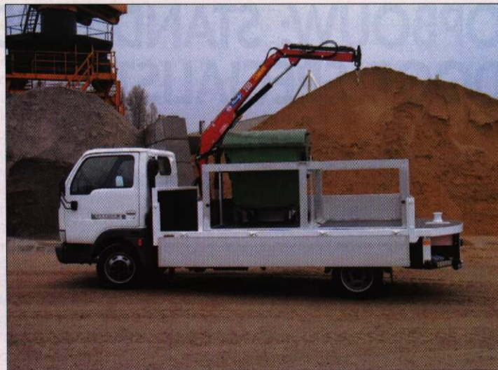
Een laadkraan verhoogt het laadcomfort, maar door zijn eigengewicht gaat dit ten koste van het laadvermogen
