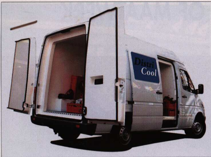
Bij geïsoleerde bestelwagens is het van groot belang dat ook de zij- en achterdeuren afdoende geïsoleerd worden
