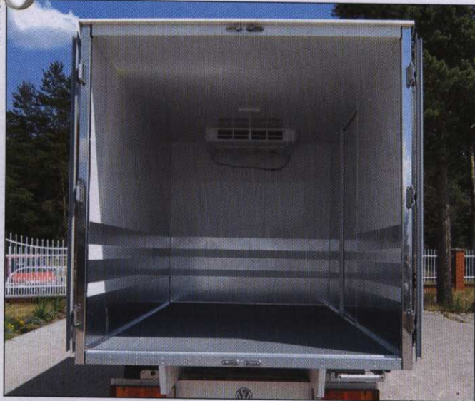
Zabudowa chłodnicza na podwoziu Volkswagena LT w wykonaniu firmy D.A.C.
